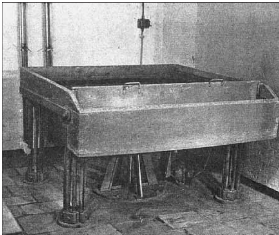
Alte Schleif- und Körnmaschine für Offsetdruckplatten, wie sie in den fünfziger Jahren in fast jeder Offsetdruckerei zu finden war. Foto: Wolfgang Walenski
