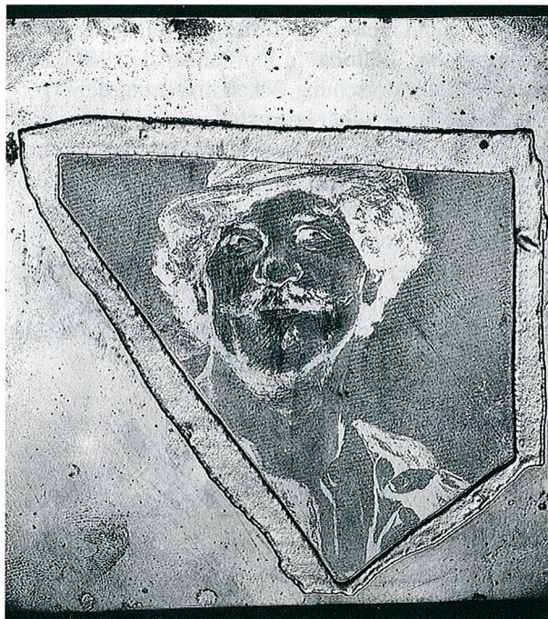
Original-Druckplatte der ersten Autotypie von Georg Meisenbach, München, 1881.
